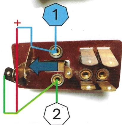
**La première pression** (horizontale) va pousser la lamelle de contact 1 (à droite) contre la lamelle d'alimentation 0 (au centre). Le klaxon de ville est activé (cosse bleue)
